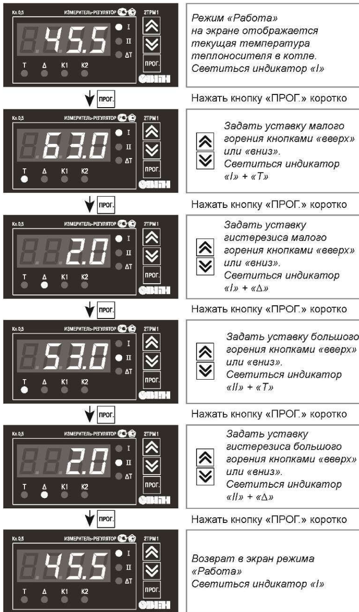
Рисунок 26. Изменение уставок малого и большого горения котла
