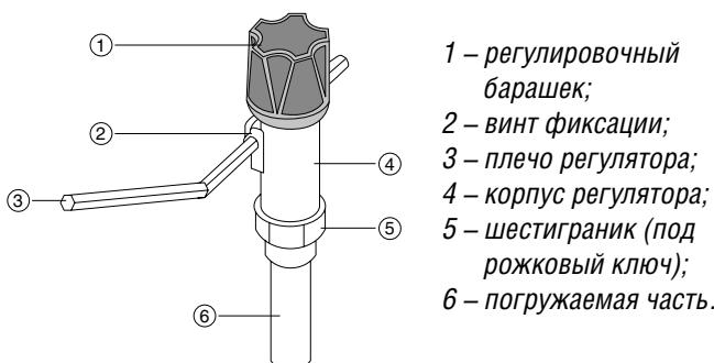
Рис. 2. Термомеханический регулятор мощности (TPM):
