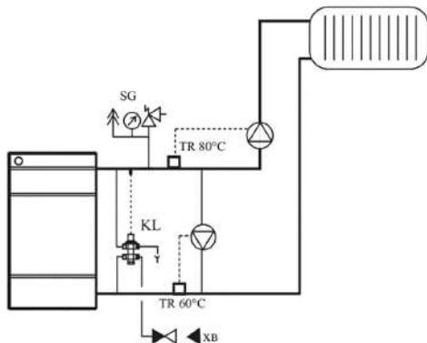
Рис. 11. Схематическое изображение системы с принудительной циркуляцией
