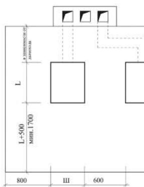
Рис. 9. Планировка котельной
