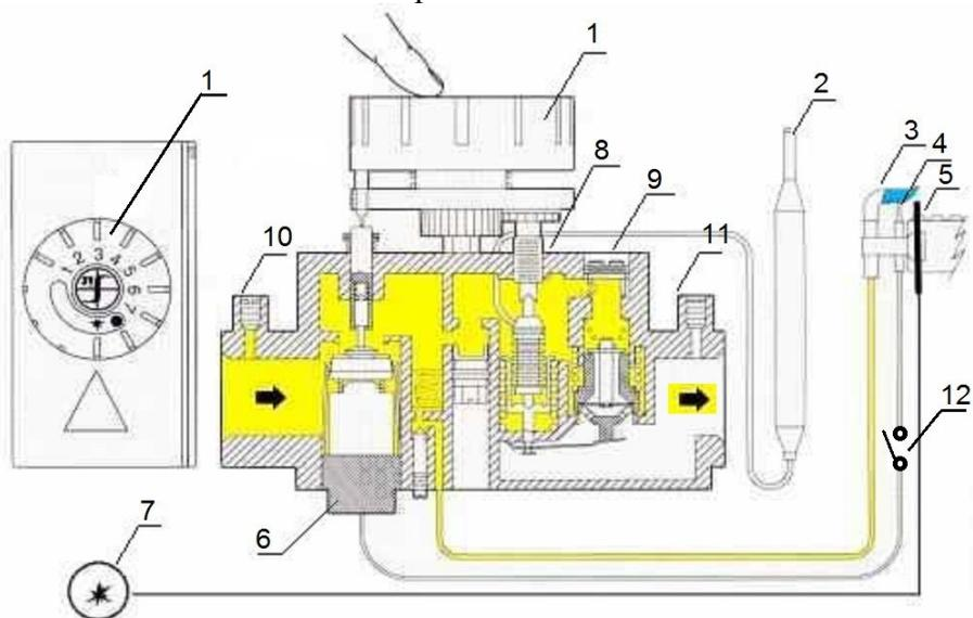
1 – ручка терморегулятора, 2 – термобаллон, 3 – запальная горелка, 4 – электрод контроля пламени, 5 – искровой электрод, 6 – электромагнит, 7 – пьезовоспламенитель, 8 – винт регулировки малого пламени, 9 – винт регулировки большого пламени, 10 и 11- отверстия для замеров давления «до» и «после» клапана, 12 – датчик тяги.
