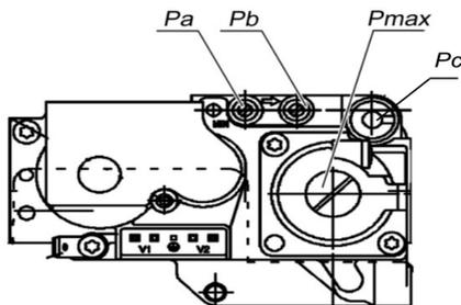
$P_a$  – давление газа на входе,  $P_b$  – давление газа на выходе,  $P_{max}$  – винт регулировки расхода газа,  $P_c$  – винт регулировки плавности розжига основной горелки
