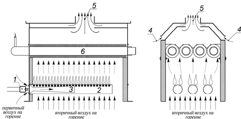
1 – газовый коллектор, 2 – рожок горелки, 3 – диффузор, 4 – стабилизатор тяги, 5 – дымоход, 6 - теплообменник.
