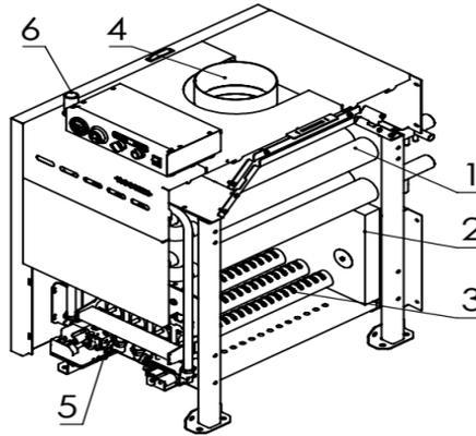
1 - теплообменник, 2 – теплоизоляция топки, 3 - рожки горелки, 4 - выход дымовых газов, 5 – газовая автоматика «HONEYWELL», 6 – вход газа.
