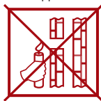
слабая тяга (Не используйте котел!)
