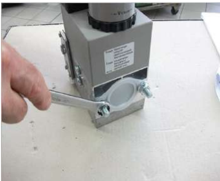
7) Снять заглушку из электроклапан;
