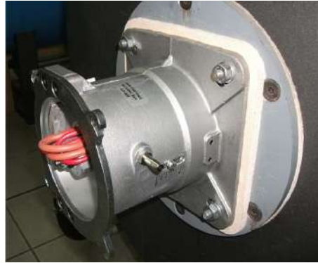
2) Смонтировать Смесительную Группу на котле;
