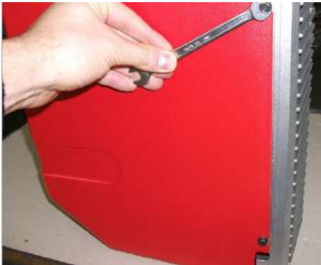
1) Снять кожух, ослабив 4 винта;
