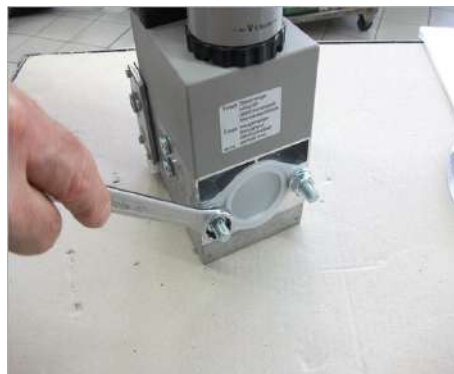
8) Снять заглушку из электроклапан;
