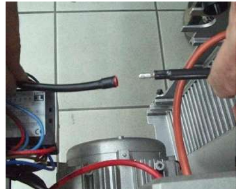
3) Отсоединить кабель электрода ионизации от разъема;
