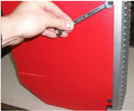
10) Снять кожух, ослабив 4 винта;
