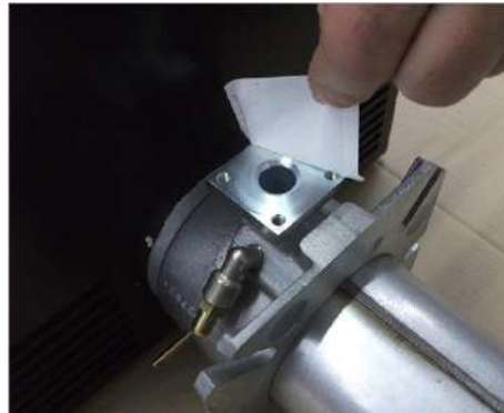
2) повернуть Горелка и Снять заглушку;
