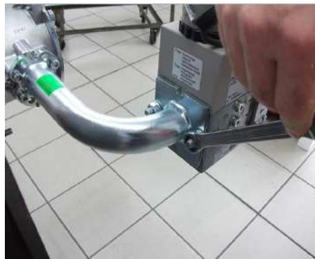
8) установить электроклапан и Прикрепить из фланец;
