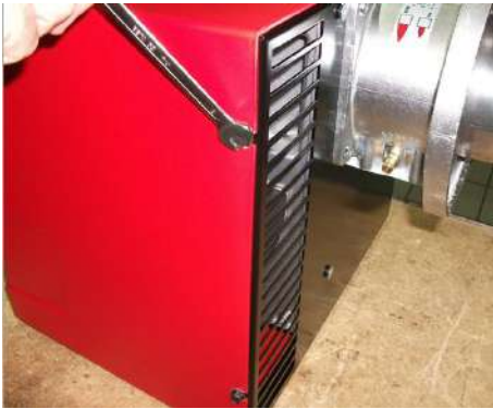
1) Снять кожух, ослабив 4 винта;
