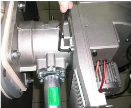
13) Зафиксировать корпус горелки к смесительной группе при помощи 4-х винтов;
