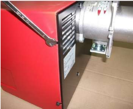
1) Снять кожух, ослабив 4 винта;
