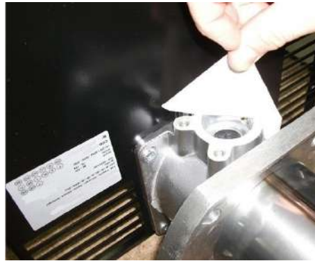
2) повернуть Горелка и Снять заглушку;
