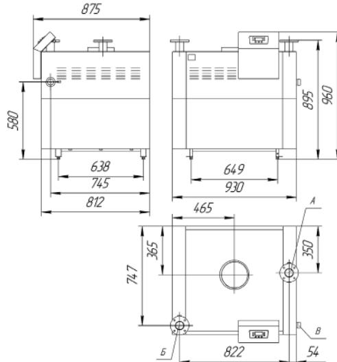
Рис. 2.1. Габаритные и присоединительные размеры котлов Clever L100
