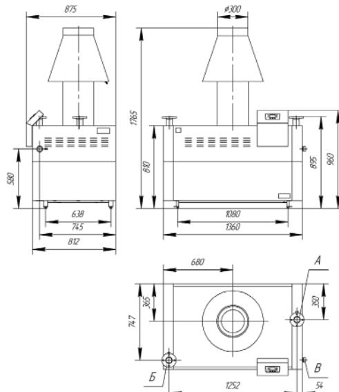
Рис. 2.2. Габаритные и присоединительные размеры котлов Clever L150
